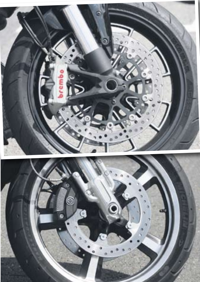
Rozdíl v každém komponentu. Brzdy obou titánů nesou značku Brembo. Ta na Diavelu je však z říše superbiků, ta na V-Rodu ze světa cruiserů
