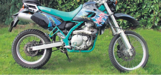
KLX650 C se řadí spíše mezi cestovnější modely. Čtyřdobé enduro má proti Áčku nižší sedlo, startér a suchou hmotnost 153 kilogramů
