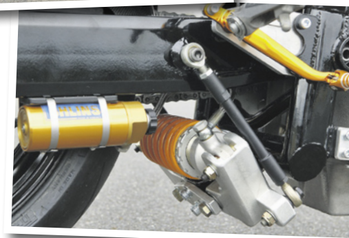
Unikátní zadní zavěšení stlačuje tlumič z obou stran
