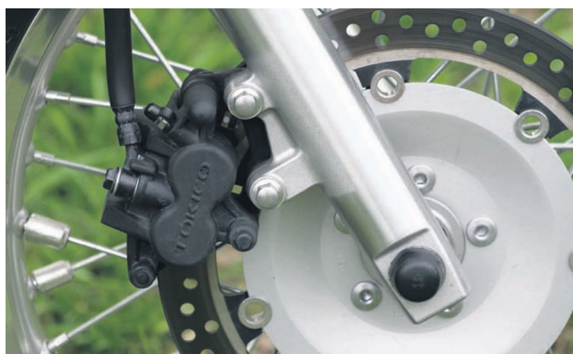
Jeden kotouč s dvoupístkem je slabinou tohoto stroje
