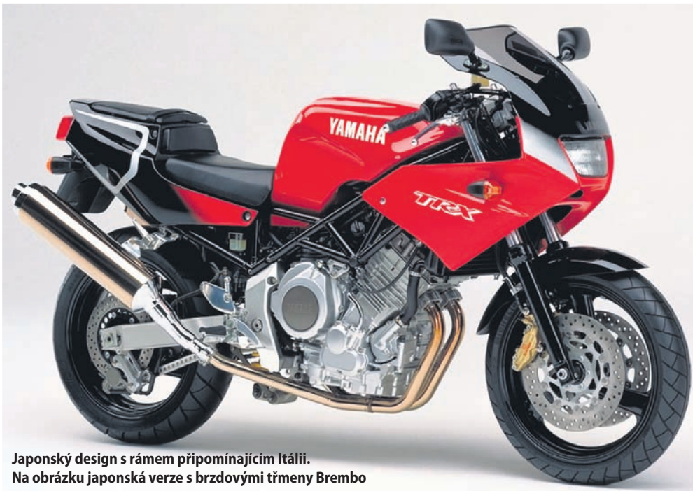
Dvouválcová osmpade má přesazené ojnicí čepy, takže páli jako věčko. Stejně to na prodejní megaúspěch nestačilo
