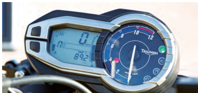
Přístrojovka se zvláštně cejchovaným otáčkoměrem je typický Triumph
