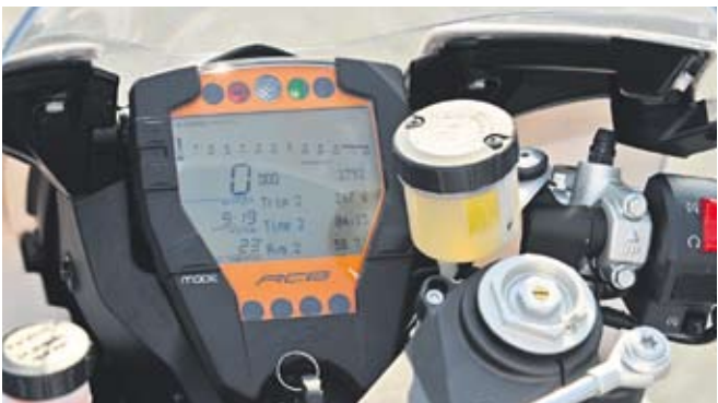
Na přístrojovce od KTM je mnoho údajů a dá se přepnout do různých módů. S čitelností za jízdy by ale někdo mohl mít problém
