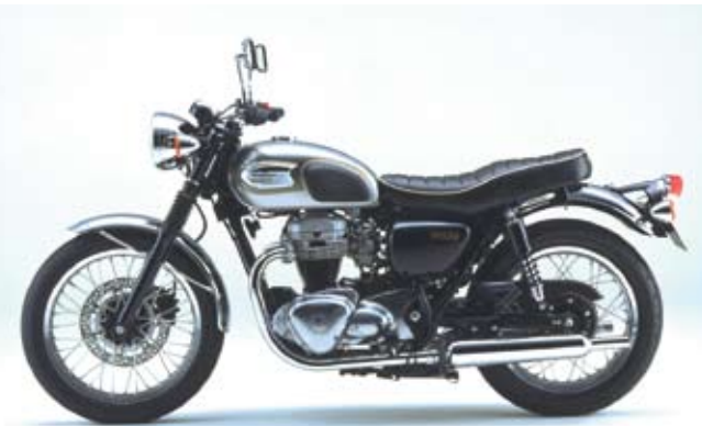
Spousta chromu, úzké pneumatiky, dva tlumiče, drátěná kola a vidlice chráněné gumovými měchy
