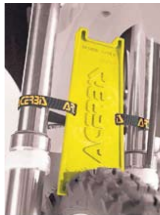
Příklady profesionálně vyráběných vzpěr přední vidlice
